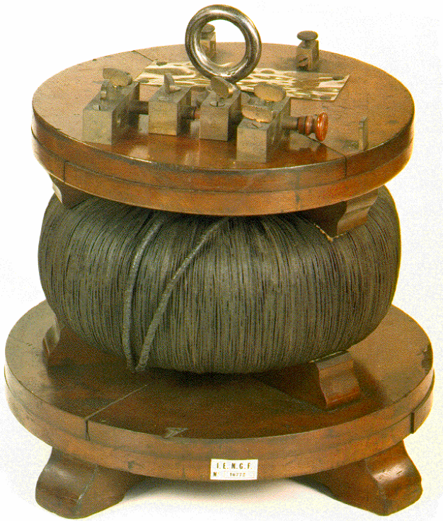
Fig. 6. Transformador de la empresa húngara Ganz & C, de Budapest, presentando como modelo de patente en Alemania en febrero de 1885 [4].
