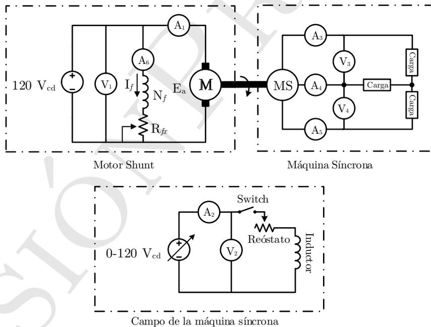
Figura 1: Conexiones para obtener la característica externa del generador síncrono.
