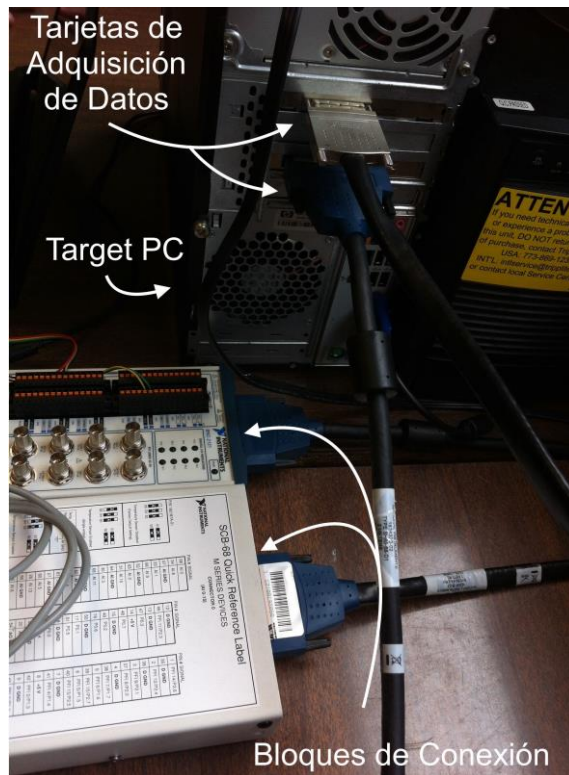
Figura 3. Conexión de las tarjetas de adquisición de datos con los bloques de conexión.
