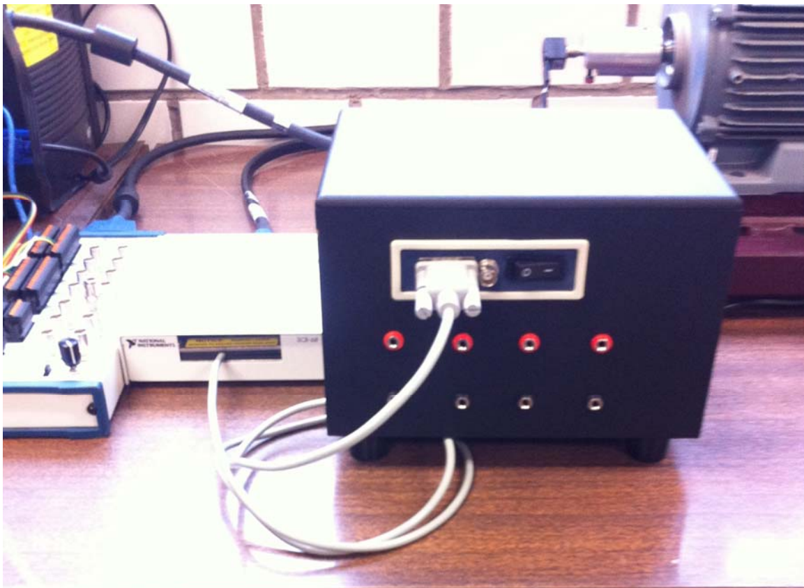
Figura 10. Conexión del MVE con la tarjeta PCI-6221
